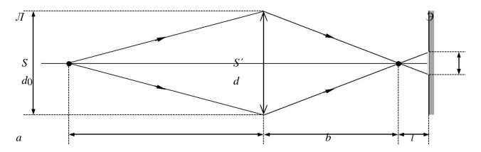
Диаметр d светлого пятна на экране нетрудно найти из геометрии рисунка через подобие заштрихованных треугольников:  $d = D_0 \frac{1}{b}$ , где b — расстояние от линзы  $\mathcal I$  до изображения S' источника S, т.е. расстояние от линзы до
