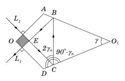
Построим ход отклонённого луча. Отметим, что сумма углов  $AB_1C_1$  и  $DC_1B_1$  равна сумме углов ABC и DCB (сумма углов в четырехугольниках одинакова). Следовательно, сумма углов  $E_1B_1O_1$  и  $E_1C_1O_1$  равна сумме углов  $EBO_1$  и  $ECO_1$ . Значит, лучи по-прежнему пересекаются в призме под прямыми углами.
