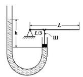
Площадь поперечного сечения трубки  $S = 10 \text{ см}^2$ , масса поршня со штоком m = 100 г. Найдите разность уровней h масла в коленах трубки, если расстояние от точки опоры стержня на шток до оси шарнира равно L/3.
